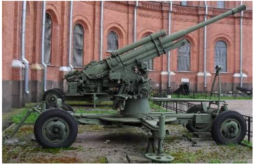
85-мм зенитная пушка обр. 1939 г. Главный конструктор М.Н. Логинов. Досягаемость стрельбы, м: по высоте - 10500, по дальности - 15500. Скорострельность - 15-20 выстр./мин. Масса, кг: орудия - 4900, снаряда - 9,2. Расчет - 7 человек.
