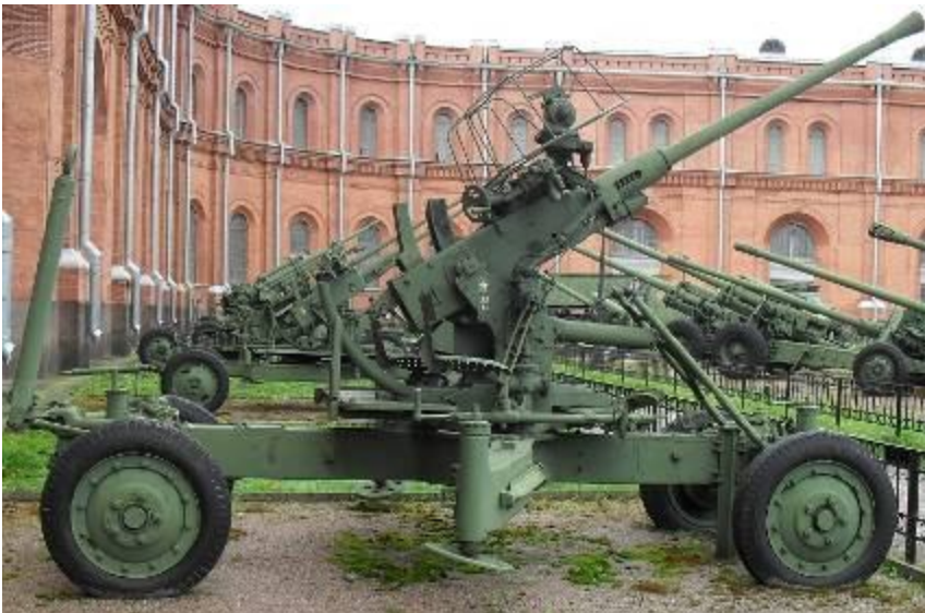
40-мм автоматическая зенитная пушка обр. 1936 г. «Бофорс». Досягаемость стрельбы, м: по высоте - 5800, по дальности - 8800. Скорострельность - 120 выстр./мин. Масса, кг: орудия - 2400, снаряда - 0,88.
