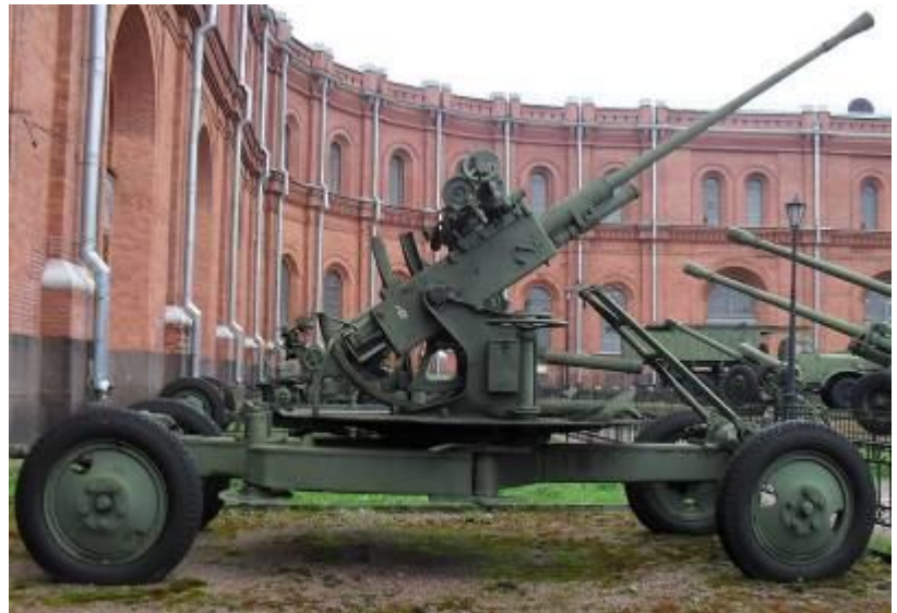
37-мм автоматическая зенитная пушка обр. 1939 г. Главный конструктор М.Н. Логинов. Досягаемость стрельбы, м: по высоте - 6700, по дальности - 8500. Скорострельность - 160-180 выстр./мин. Масса, кг: орудия - 2300, снаряда - 0,73. Расчет - 7 человек.
